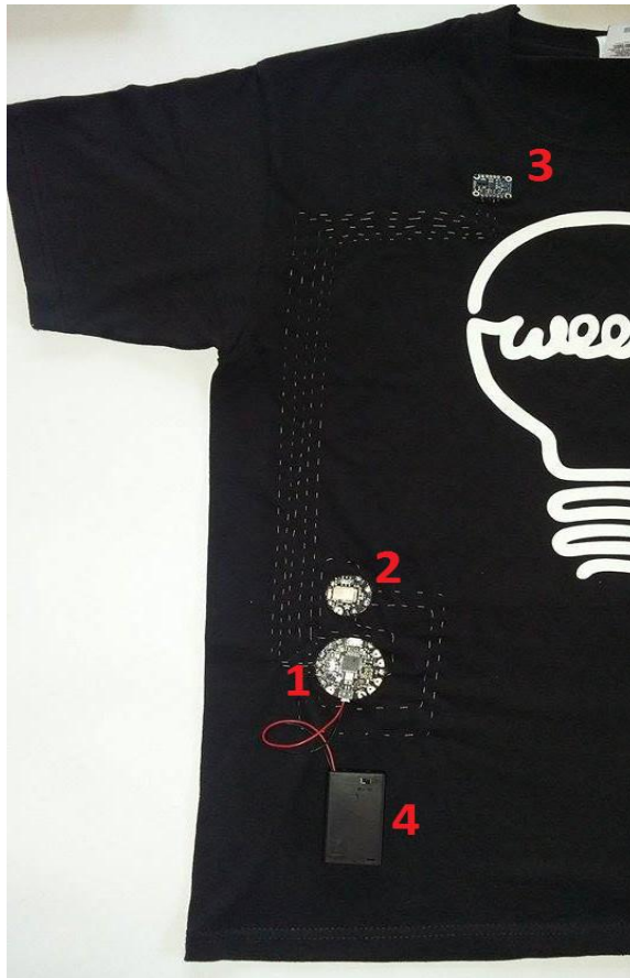
Rysunek 1 Elektroniczny system służący do lokalizacji inercyjnej wszyty w koszulkę tekstylną
