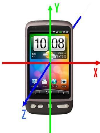
Rysunek 3 Telefon wyposażony w akcelerometr rzutowany na układ współrzędnych
